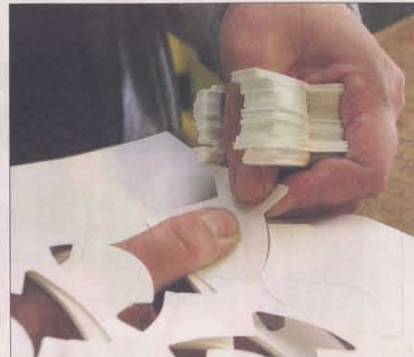
Een paar keer per jaar stanst De Bie stukjes karton van een paar centimeter in omtrek. Na het stanzen, drukt Marga Jeeninga de kartonnetjes uit de vorm en bundelt ze in een vast aantal. Marga werkt overdag veel mee. Ze is vooral voor het precisiewerk, zoals het plakken of nieten van doosjes. Ron: "Dat klinkt misschien vreemd, maar dat is typisch vrouwenwerk. Wanneer Wolter of ik dat moeten doen, wordt het direct een puinhoop." Marga is de eerste om dit verhaal lachend te bevestigen. (Foto: Sietse de Boer)
