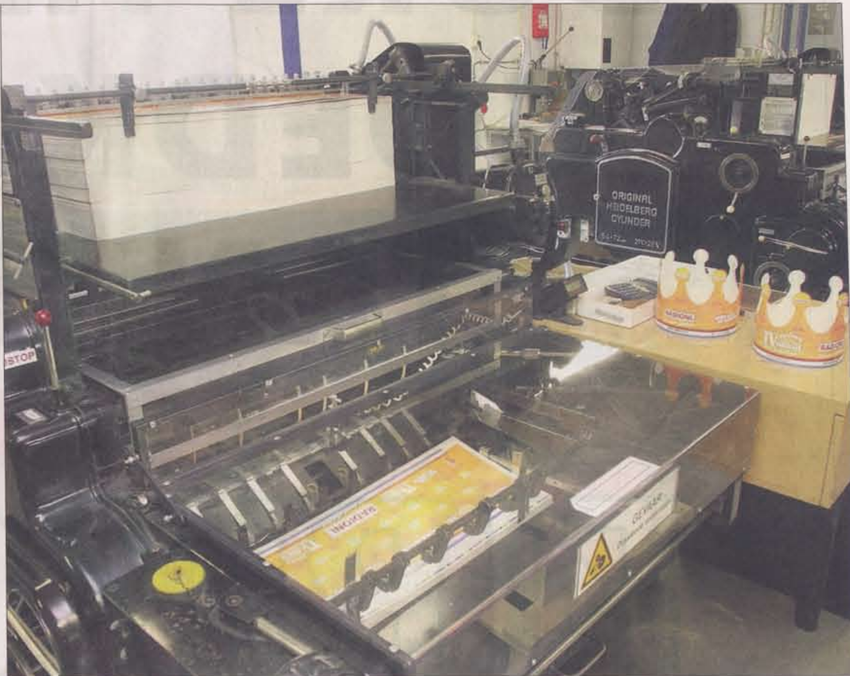
De Heidelberg cilinderautomat aan het werk met het eindresultaat. Draait de Heidelberg vol gas, dan verwerkt de machine 2500 vel per uur. (Foto: Sietse de Boer)
