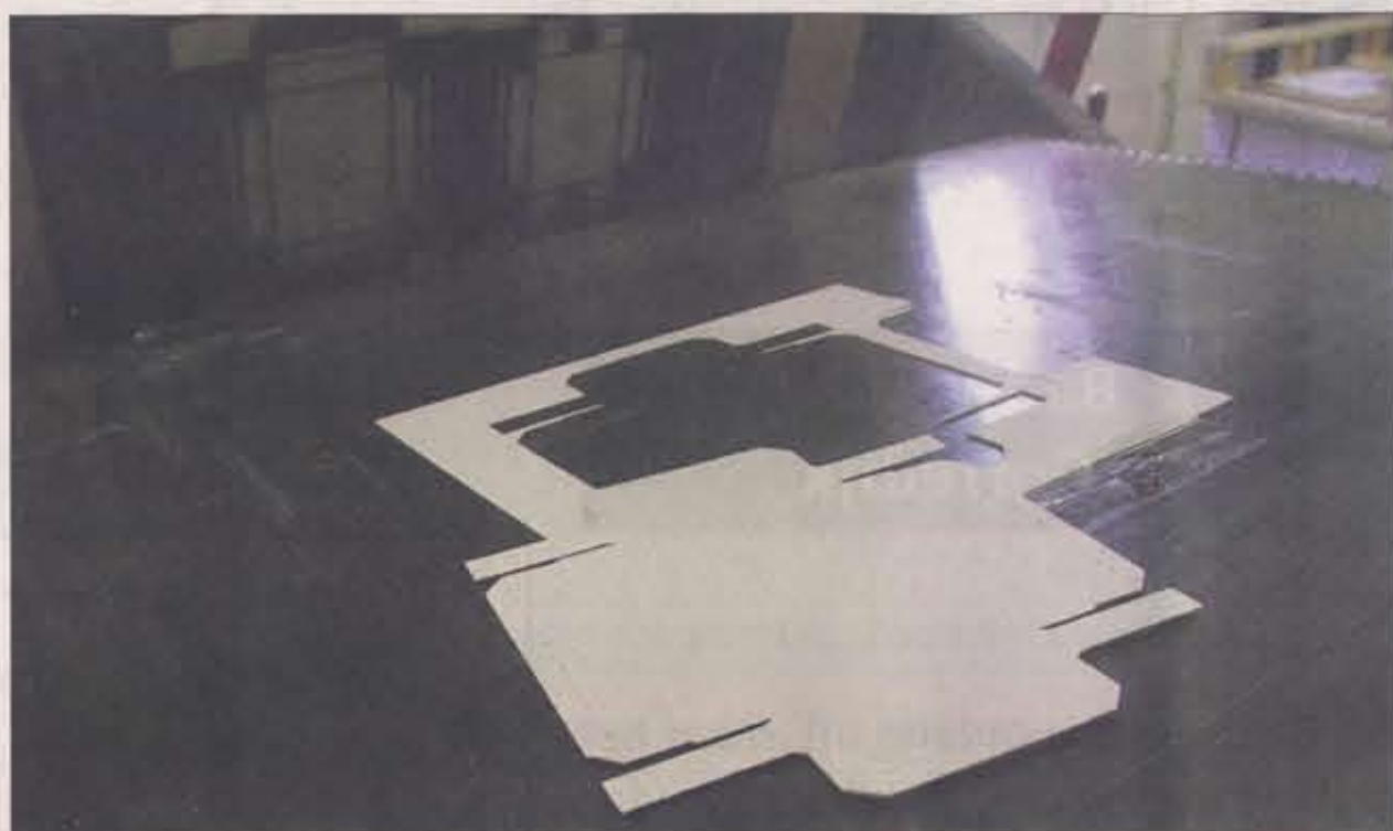
In één werkgang stanst en rilt De Bie platen karton tot vormen waaruit eenvoudig doosjes zijn te vouwen. Deze machines, Degels, werken als een wafelijzer. Aan één kant het karton en aan de andere kant een stansvorm. (Foto: Sietse de Boer)
