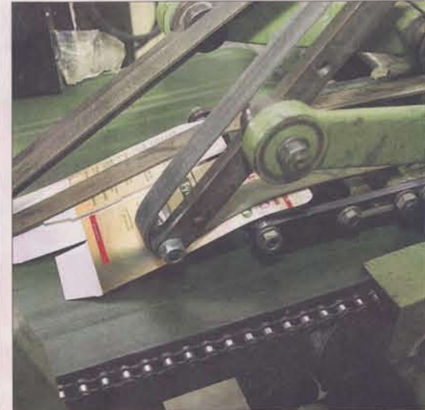
De plakmachine vouwt en plakt per uur maximaal 15.000 doosjes. De doosjes worden vooral gebruikt voor de verpakking van cosmetica en medicijnen. "Het is een prachtige machine, het omstellen duurt maar een paar minuten en dan rollen er opnieuw zo maar 15.000 doosjes per uur van de band," aldus De Bie. (Foto: Sietse de Boer)
